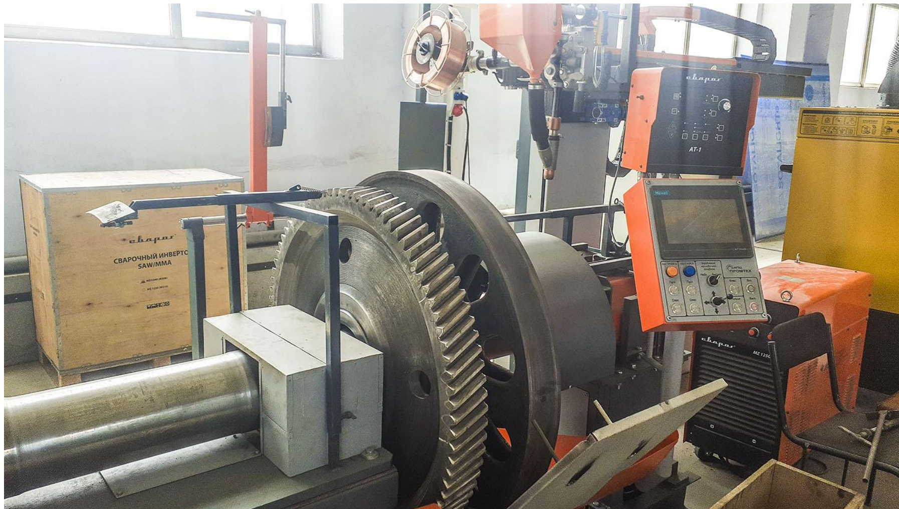
УСТАНОВКИ АВТОМАТИЗИРОВАННОЙ НАПЛАВКИ ЭЛЕМЕНТОВ КОЛЕСНЫХ ПАР
