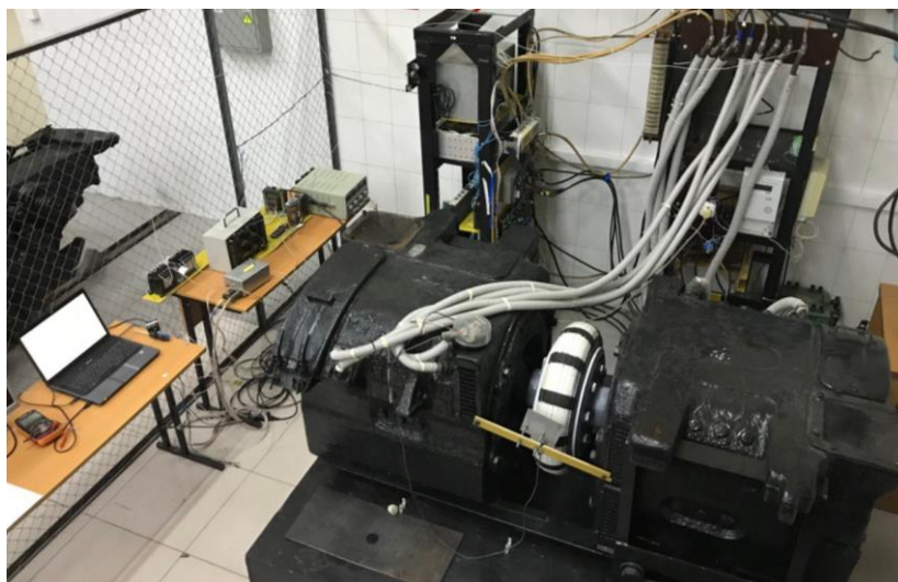
Рисунок 6 – Внешний вид физической модели электровоза с подключённой системой мониторинга сопротивления изоляции
