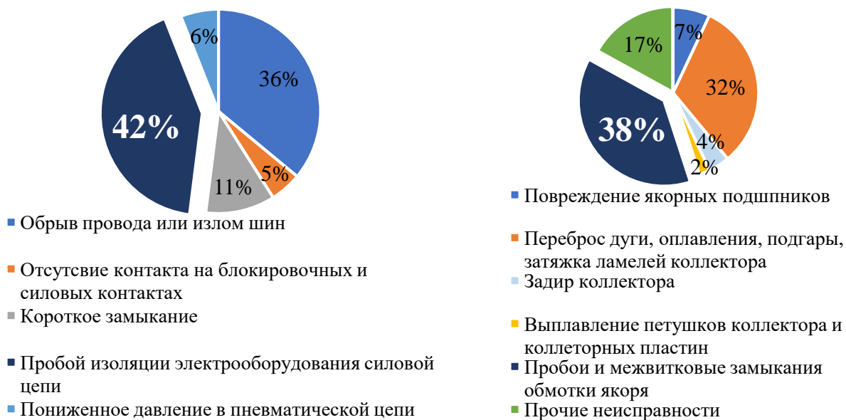
Рисунок 2 – Причины выхода из строя электровозов серий Э5К, 2(3)ЭС5К Восточно-Сибирской дирекции тяги за 2024 год а) – электрооборудования; б) – ТЭД
