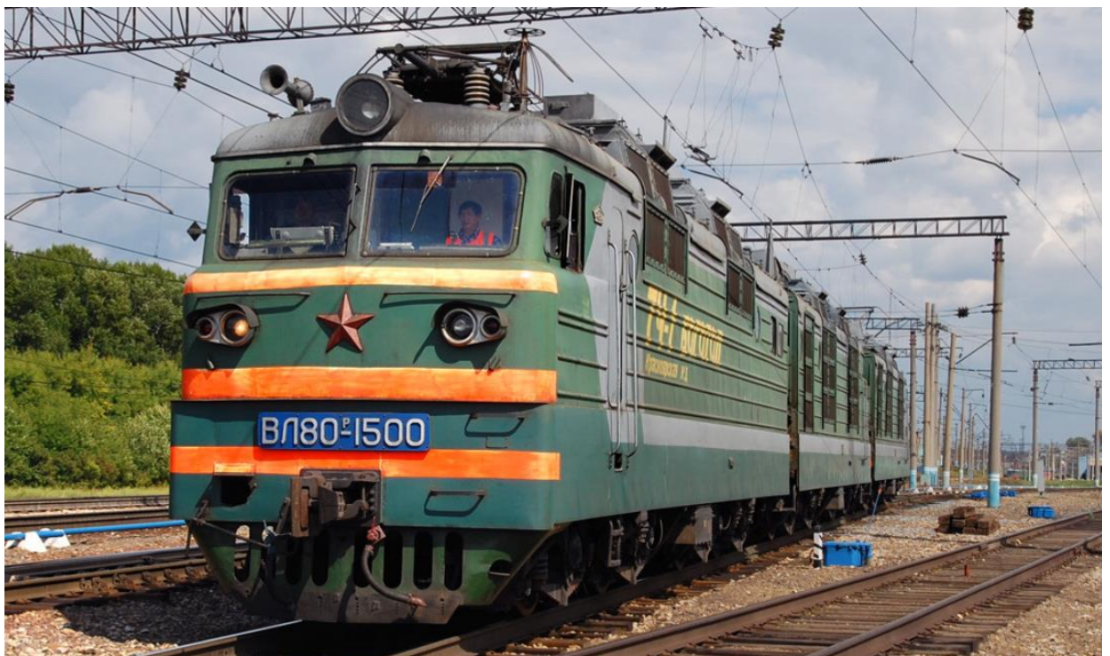
Рисунок 2 – Первый серийный электровоз с ВЭП
