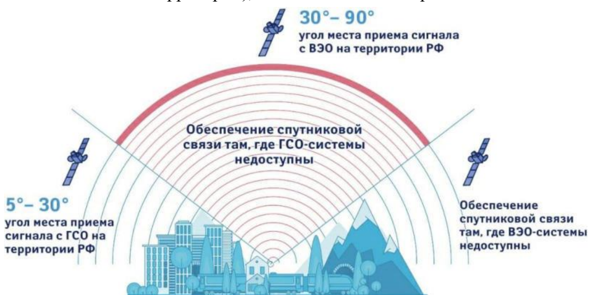
Рисунок 1 – Углы места для КА, функционирующих на ГСО и ВЭО
