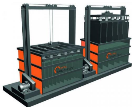
Нагрузочный модуль реостатных испытаний ДГУ
