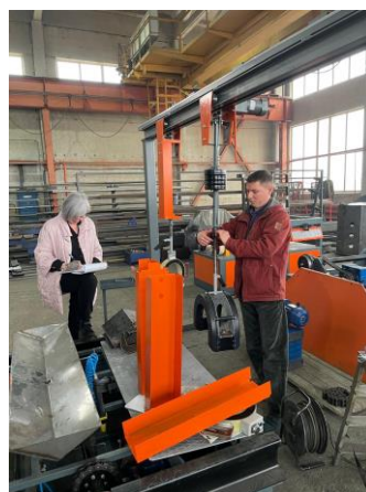
Стенд дефектоскопии колесных пар
