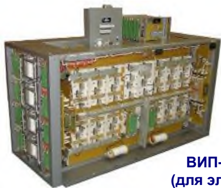
ВИП-4000-М-УХЛ2 (для электровозов ВЛ-80Р(КРП1), 2ЭС5К, ЗЭС5К, ЭС5К)
