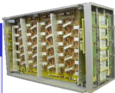
ВИП-5600-УХЛ2 (для электровозов ВЛ-65, ЭП1, ЭП1М)
