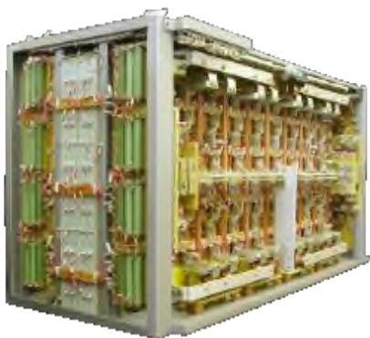
ВИП-4000-М-УХЛ2 (для электровозов ВЛ-80Р(КРП1), 2ЭС5К, ЗЭС5К, ЭС5К)
