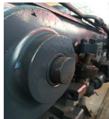
Упор-ограничитель после ремонта в объеме ТР-600
