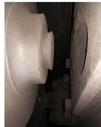
Износ пальца упора-ограничителя горизонтальных перемещений тележки и упорной плиты рамы кузова в эксплуатации
