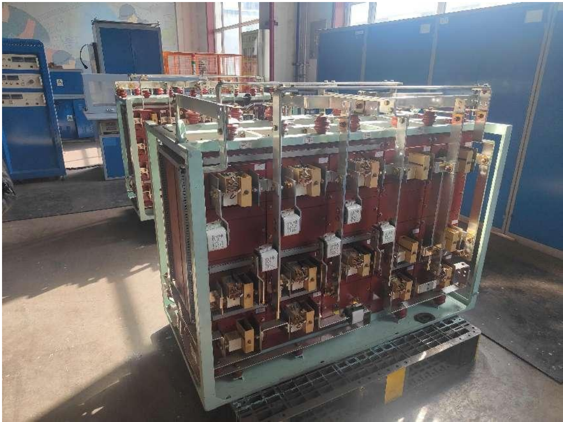
图 6: SS3B 电力机车整流柜实物照片
