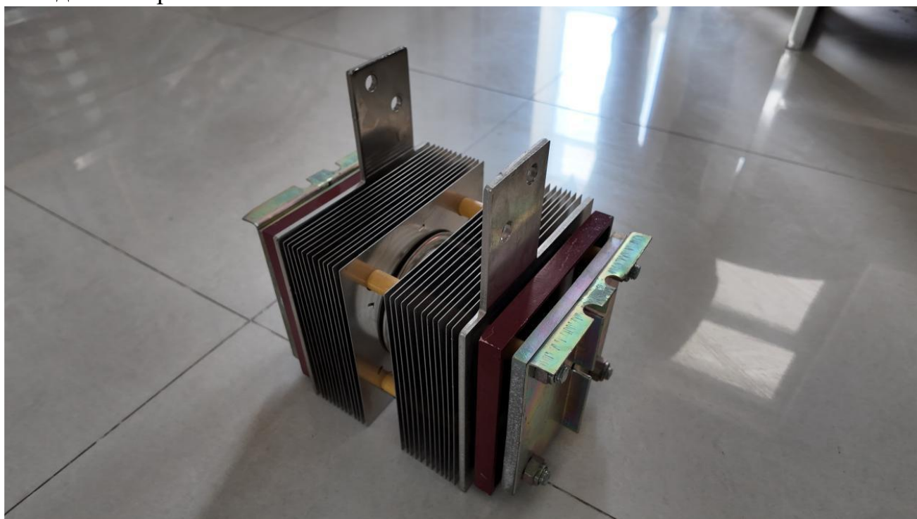
Рисунок 5: Общий чертеж электронных компонентов и радиатора в сборе
