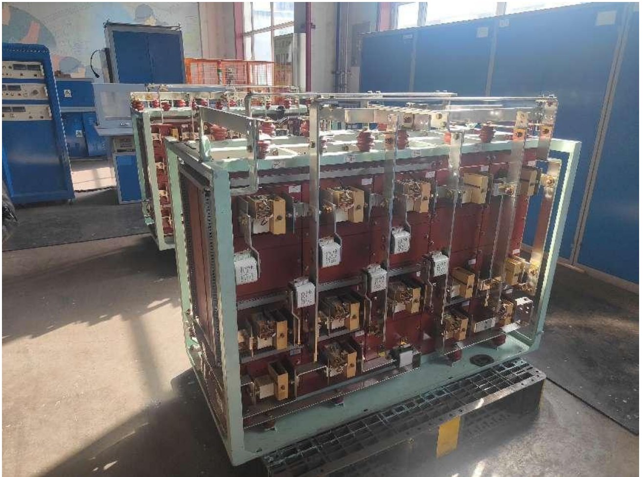
Рисунок 4: Фотография силового шкафа электровоза SS3B.
