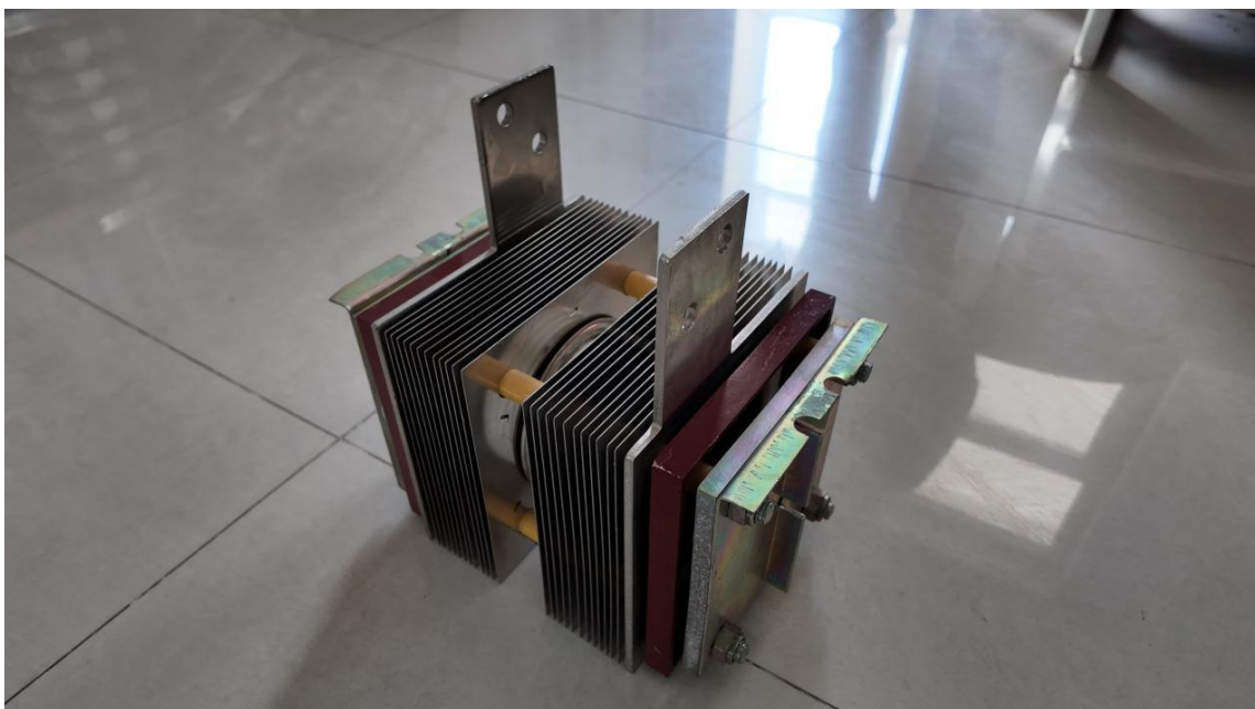
图 7: 改造前各元件加散热器的外形图
