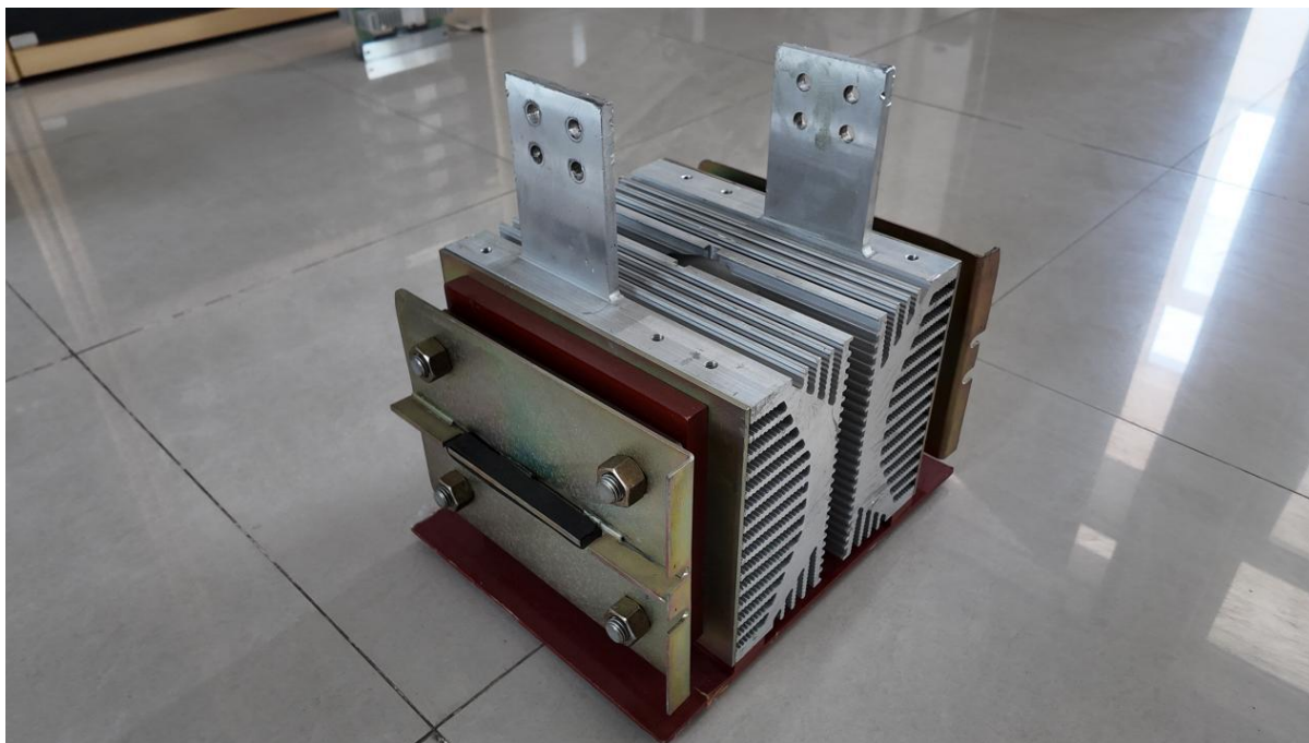
图 8：改造后各元件加散热器的外形图
