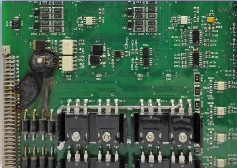
Характерные последствия выхода из строя блока БВВ-057.
