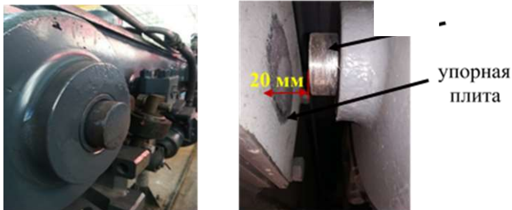
Рисунок 5 – Новый упор-ограничитель после ремонта в объеме ТР-600
