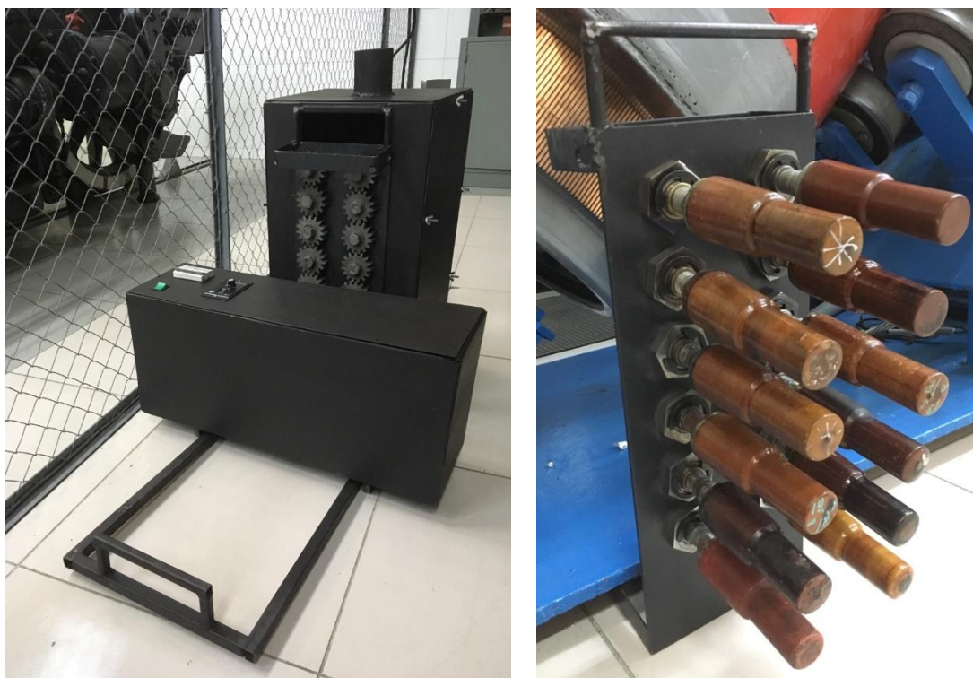
Рис.2 – Установка для сушки изоляционных пальцев ТЭД камерного типа
