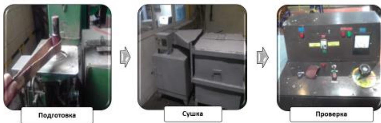
Рис.1 – Этапы восстановления изоляционных пальцев при деповском ремонте
