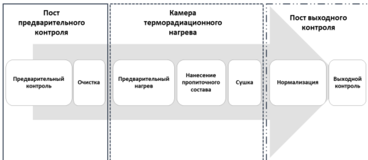
Рис.3 – Установка для сушки изоляционных пальцев ТЭД камерного типа
